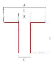
Der EPDM Klebe-Gully ist in den Nennweiten (DN) 50 bis 150 erhältlich. Der Flanschdurchmesser (A) beträgt je nach Ausführung 235 bis 380 mm. Der Stutzen (h) kann auf die gewünschte Länge gekürzt werden.
